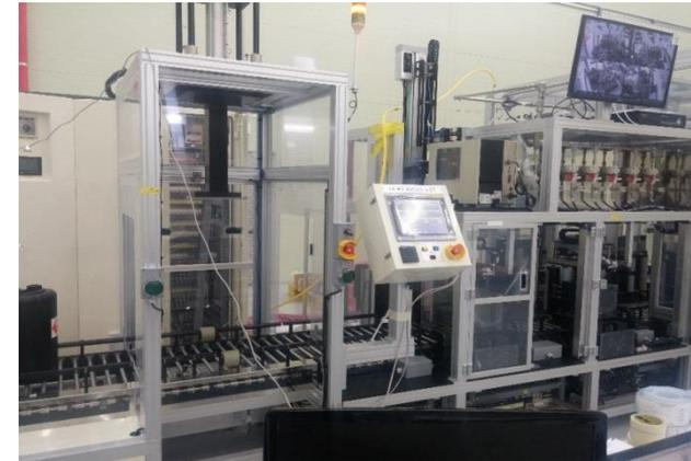
▣ Bottle 용량별 분류 및 염료 충진을 C/V를 통하여 자동화 설비. (구미 SDI 설치)
