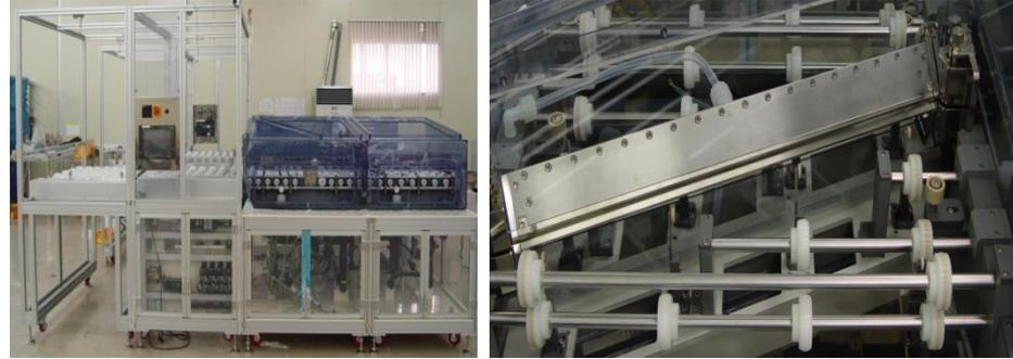
■ LCD Glass 세정 및 건조를 위한 세정 장비.
