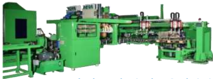
측판 조립 및 자동용접라인
